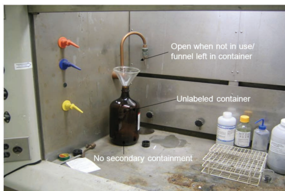
1. ábra: A hulladékoldószer nem biztonságos gyűjtése
