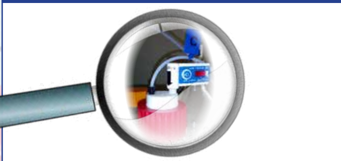
1. ábra: biztonsági kupakkal zárt eluenstartó
